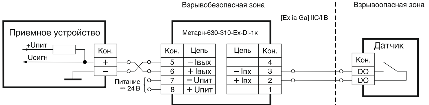
Рисунок Б.4 — Схема подключения барьера Метран-630-310-Ex-DI-1к к датчику без реализации функции контроля цепи
